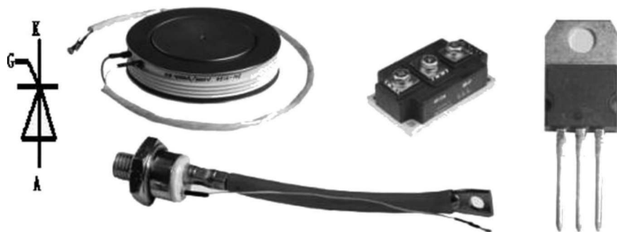
图 1-1 单向晶闸管的符号和外形
