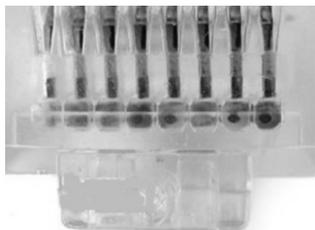
图 1-2-3 插入电缆后的水晶头顶面
