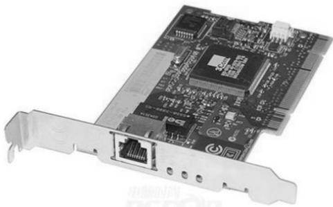
图 1-2-5 10M/100M 自适应网卡
