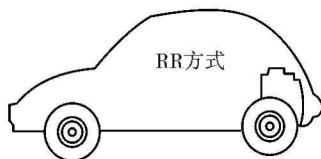
图1-10 发动机后置,后轮驱动
