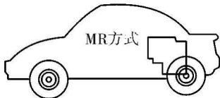
图1-11 发动机中置,后轮驱动
