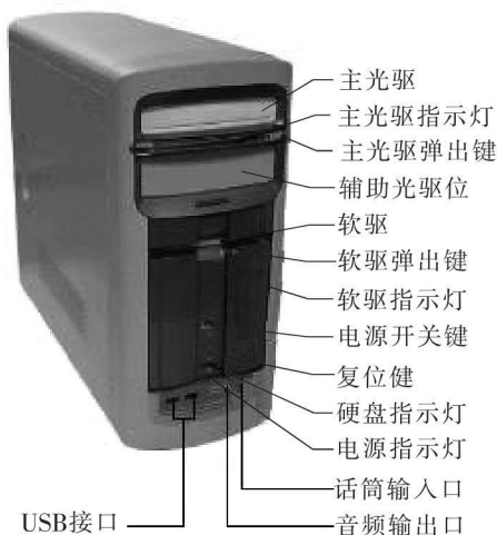
图 1-4 主机箱前面板图
