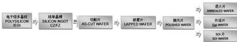
图 1.3 半导体硅片的生产流程和产品系列
