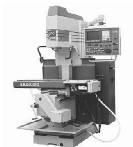
图 1-3 主轴头升降式数控铣床
