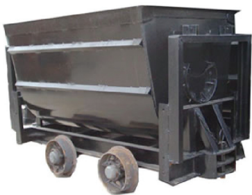
▲ 图 1-2-3 单侧曲轨侧卸式矿车
