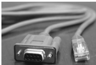
图 1-1-4 交换机配置线缆
