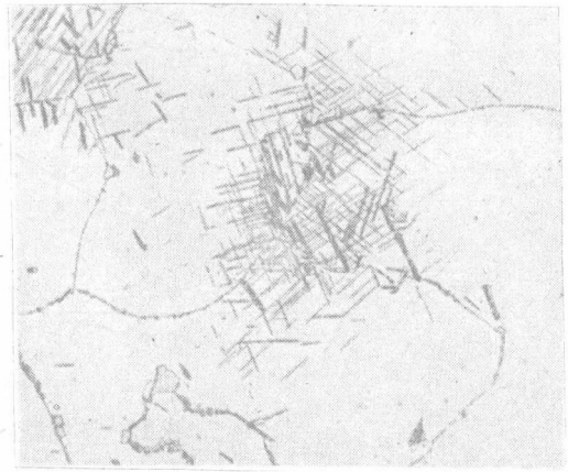
图 9 经 1200^{\circ}\text{C} \times 2\text{h} + 850^{\circ}\text{C} \times 10\text{h} 处理 \times 500
