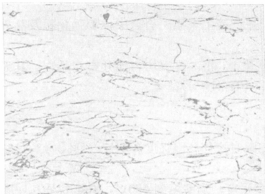
图 5 锻态显微组织的晶粒度
