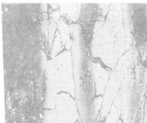
图 5 温加工持久断裂裂纹 ×500
