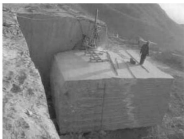
图1-4 在岩体上切割建材石料
