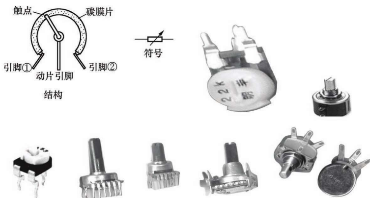
图 1-3 常用可变电阻器电路符号及实物外形
