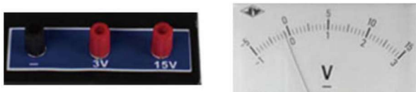
图 1.2.6 直流电压表接线柱及刻度
