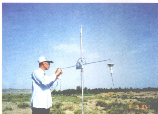
陈家宜教授利用北大研制的 Bowen 比观测系统在戈壁绿洲边界进行实地观测
