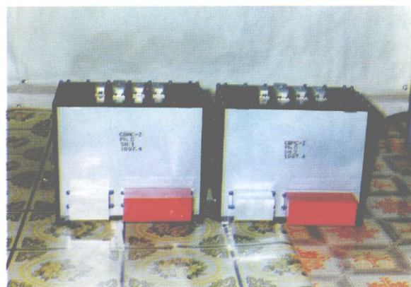
空间物理专业与技术系共同研制的星内粒子探测器正样产品
