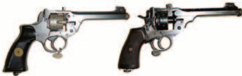
上二图：左右两图分别为改装点 22 转轮适配器的恩菲尔德左轮（左）和韦伯利左轮（右）。 中组图：使用点 22 长方形单发适配器的韦伯利 Mk VI 左轮手枪与普通手枪进行对比。
