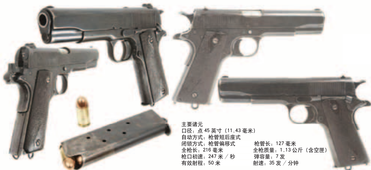
柯尔特 M1911 (.455inch) 手枪细节组图（1914 年，美国柯尔特公司专门为英国军队生产的点 455 口径型）
