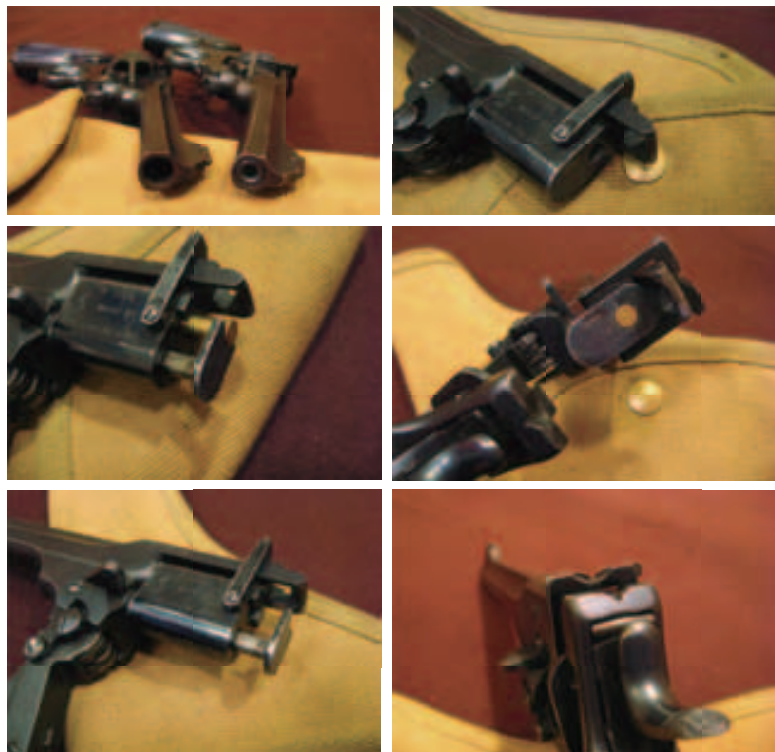
下组图：使用装填器进行英制左轮手枪子弹装填流程（以韦伯利 Mk VI 为例）
