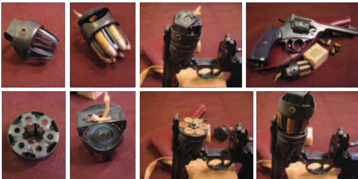
下组图：使用装填器进行英制左轮手枪子弹装填流程（以韦伯利 Mk VI 为例）
