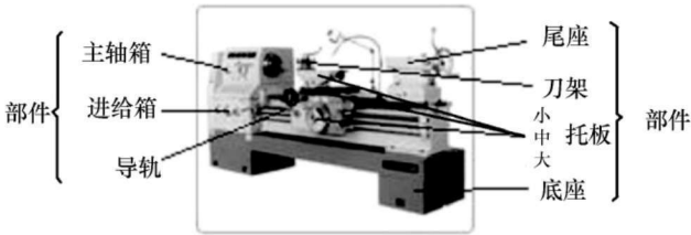
图 1-1-11 车床的主要组成部件
