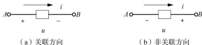
图 1-9 电压、电流方向的关联性
