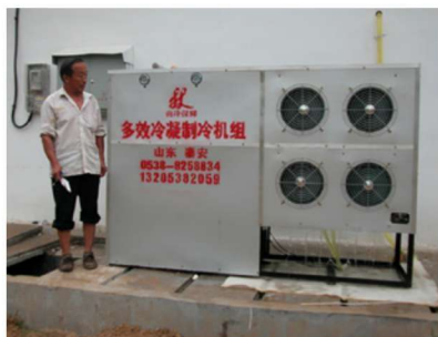
多效冷凝 20 ~ 30 kW 机组 (150 ~ 200 吨库用)
