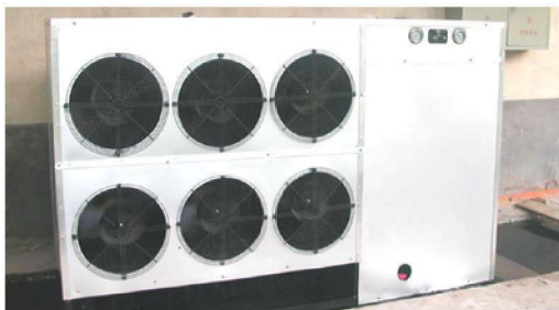
土建装配复合式 200 吨自动冷库（多效冷凝制冷机组地下储水池式）
