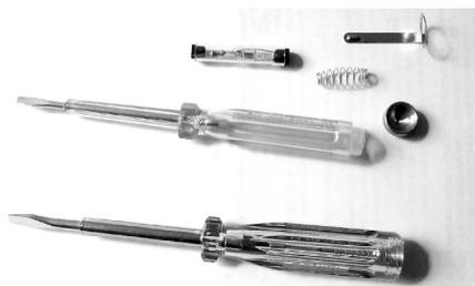
图 1-1 低压验电器
