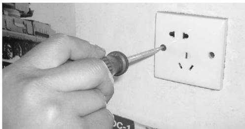
图 1-6 大螺钉旋具的使用方法
