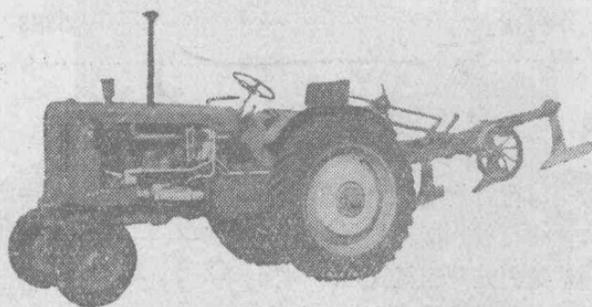
該机是輪式中耕拖拉机。它可用于耕地、耙地、播种、中耕、收获等田間作业，也可用于脫粒、排灌等固定动力作业和运输。
