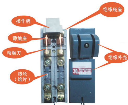
闸刀开关内部结构图例
