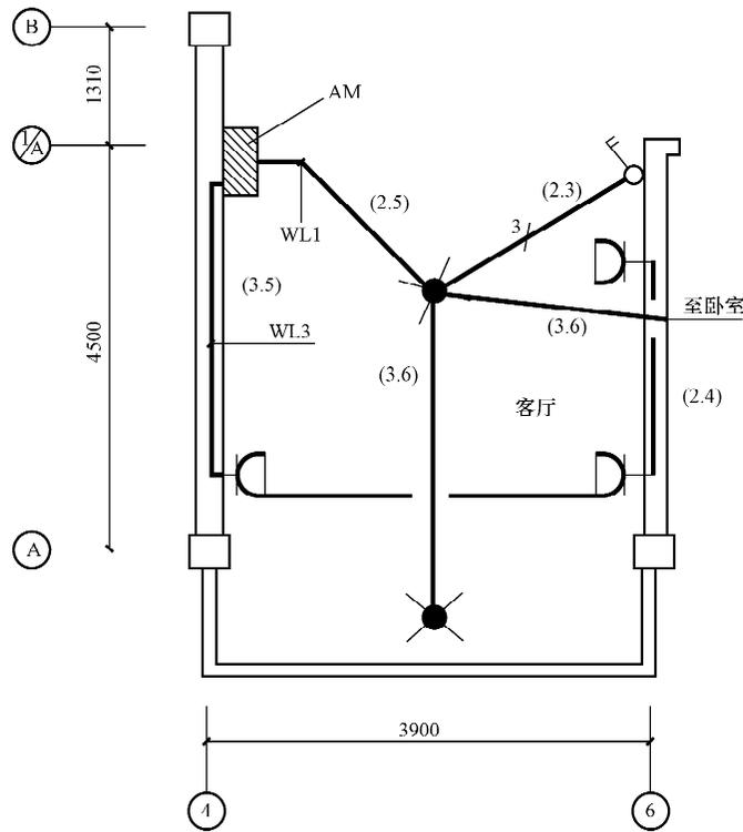
图 1-1-2 某住宅楼客厅局部照明平面图
