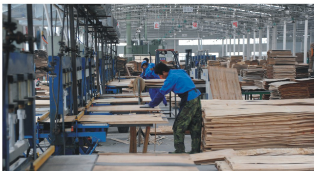
桂巽板业公司工人正在进行单板拼接
