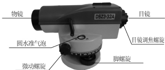
图 2.3 DSZ3 型水准仪构造
