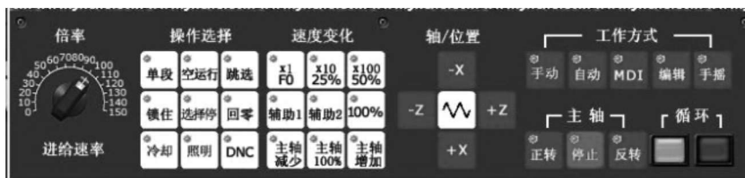
图 1-1-7 FANUC 0iT CKA6136 型数控车床的机床控制面板
