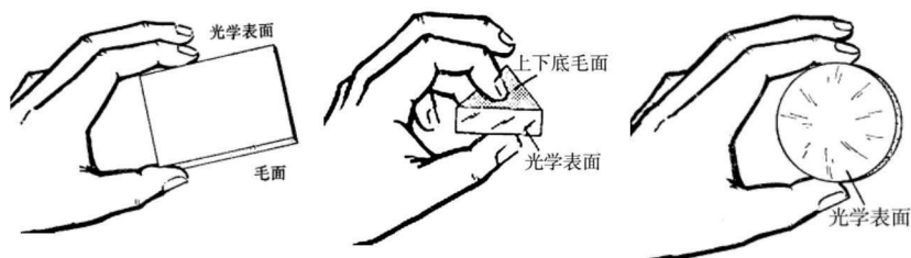
图 0-2 光学元件正确拿取方法
