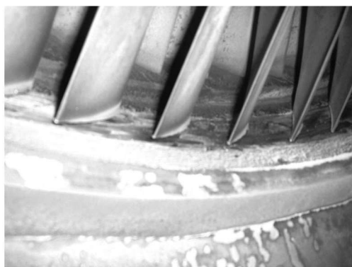
图 1-2 末级叶片有明显磨损
