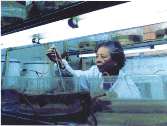
原生物学家沈祖芬利用恒流 稀释微宇宙装置做PFU法的群落级毒 性试验
