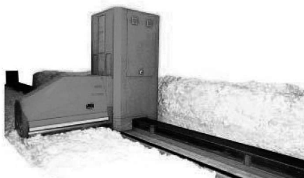
图1-5 FA009系列往复式抓棉机外形图
