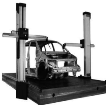
图 1.1 用于生产线上的双水平臂测量机
