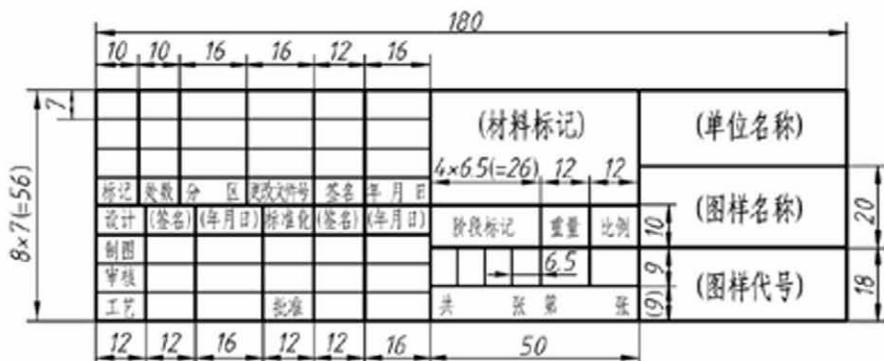
图 1-4 标题栏的格式及组成部分的尺寸
