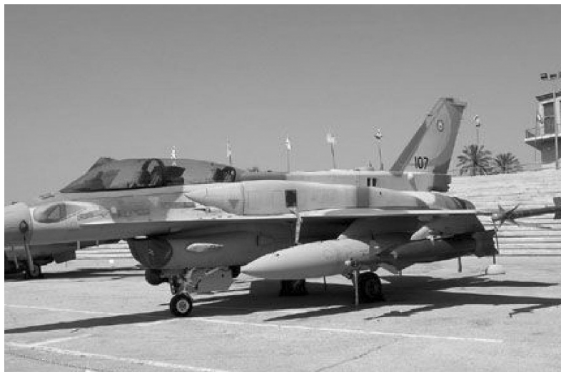
图 2-1-1 挂载在 F-16 战斗机上的 Litening II 吊舱(机身下部)
