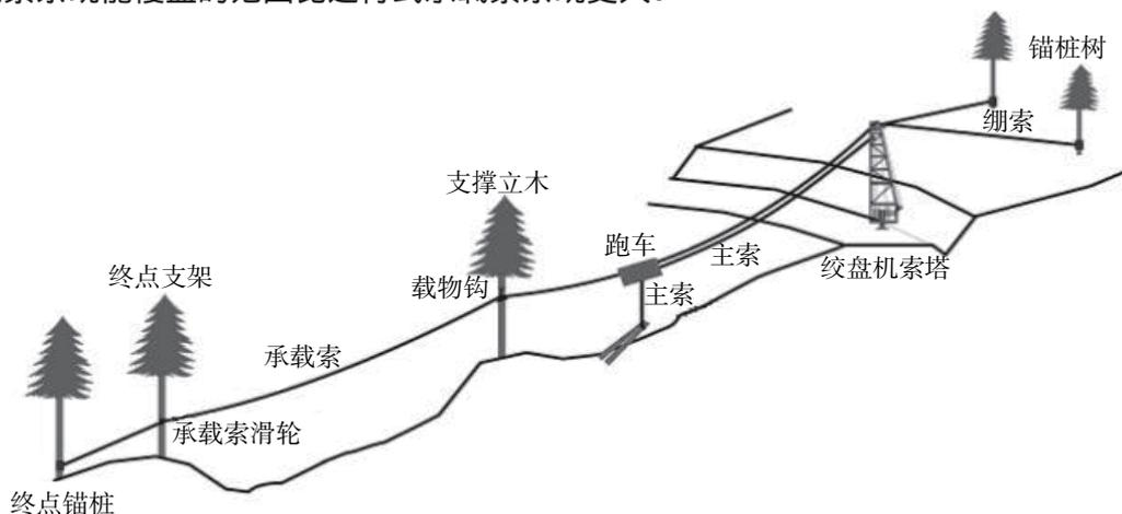
图1 含有支撑立木、终点支架（终点立木）和锚桩树的逆坡固定式承载索系统（根据 Stampfer et al.,2006 图片修改）
