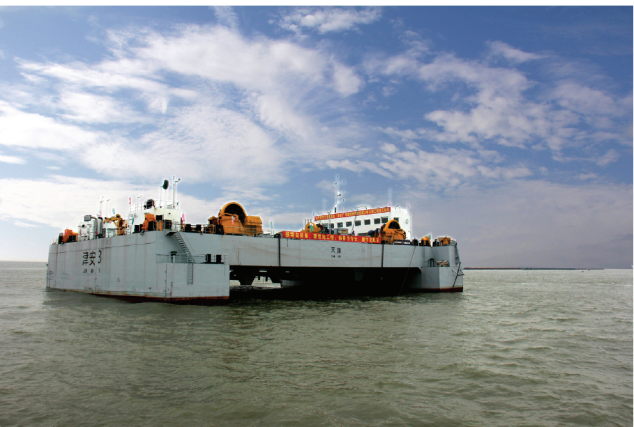
“津安3” 沉管安装船
