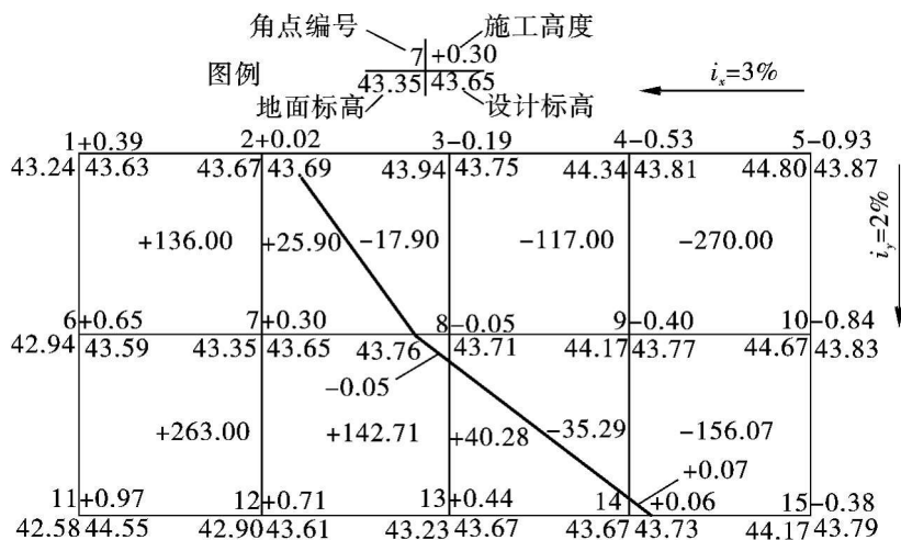
图1-4 方格网法计算土方工程量
