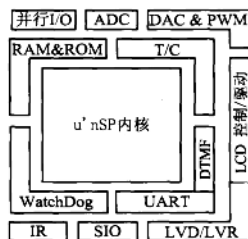
图 1.1 \mu'nSP^{TM} 家族的模块式结构
