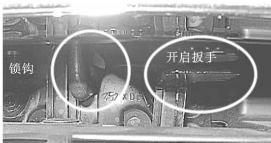
图 1.5 发动机舱盖锁钩及开启扳手
