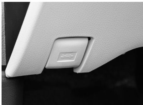
图 1.4 发动机舱盖开启拉杆
