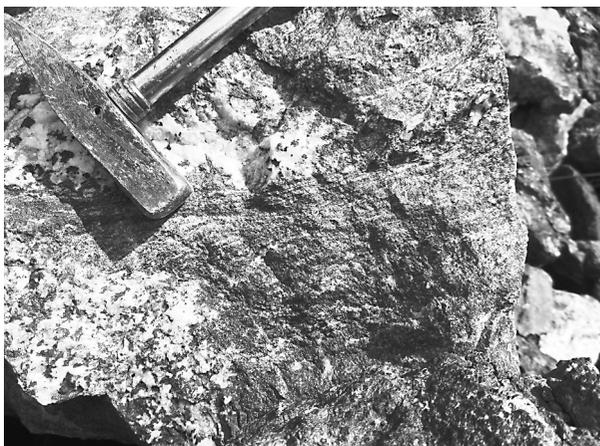
图2 变余纹层状构造矿石
