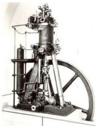
图 1.12 鲁道夫·狄塞尔发明的柴油机
