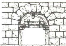
6. 将缺口做整齐,在缺口上方摆起楔形的石块(拱石)使之互相支撑,用一个木架将其稳住,拱做好后再把木架拿走。
