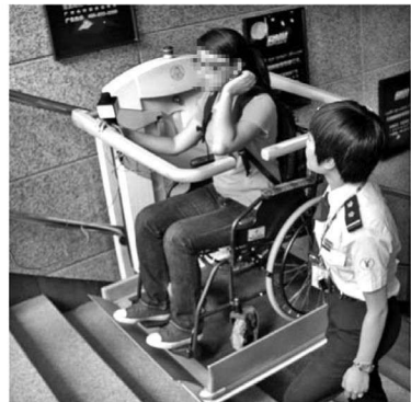
图 1.4 地铁车站无障碍电梯
