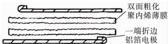
(d) 元件介质结构示意图
