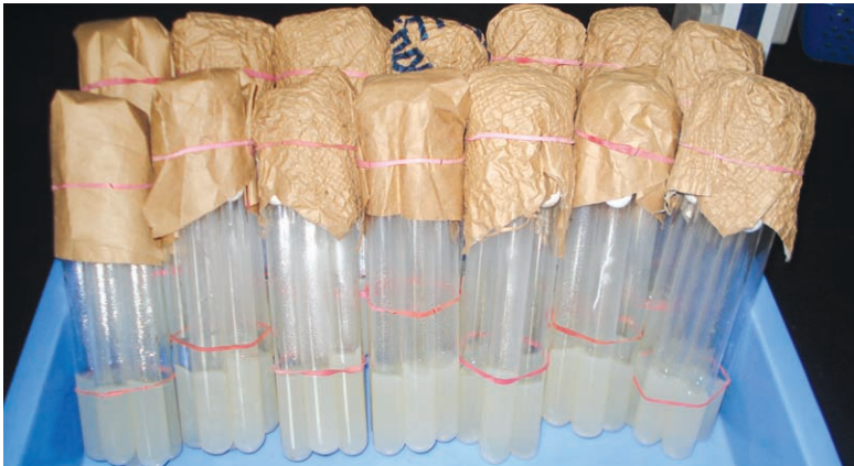
用牛皮纸把棉塞包裹，防止灭菌时棉塞受潮
