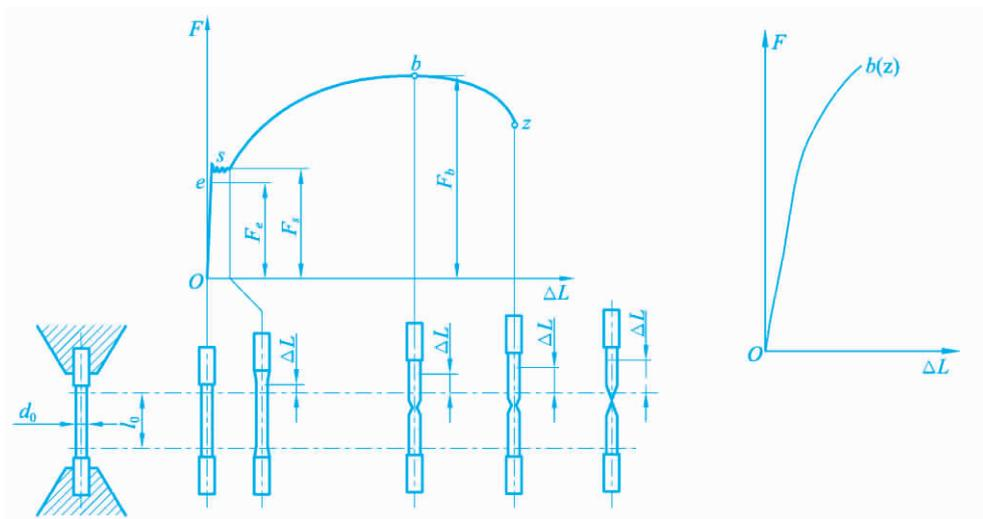
图 1-2 低碳钢的拉伸曲线图
