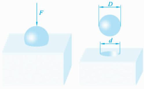
图 1-4 布氏硬度实验原理示意图
