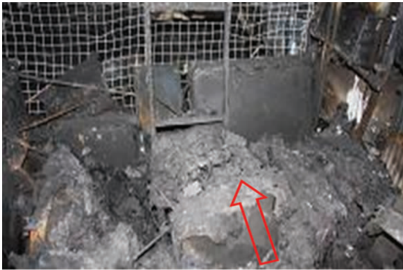
图 19 木椅框架上部电视机向东侧倒落
