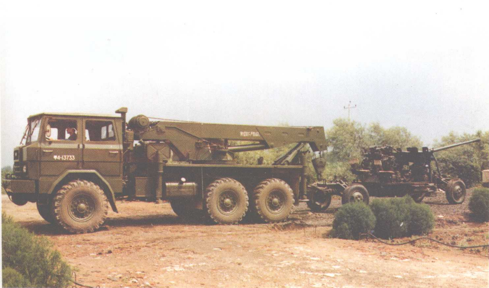
QA101 型10吨起重抢救车，在吊牵75高炮行驶。
