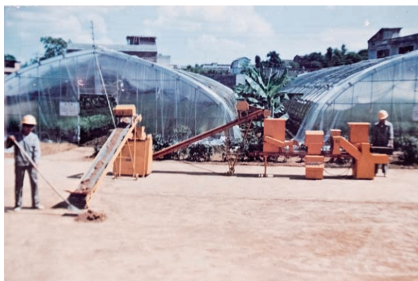
图 2-1-27 广西横县华南容器育苗工厂的育苗工艺流程布局
