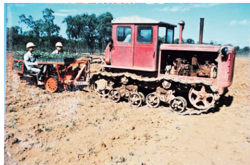
图 2-1-37 拖拉机牵引植树机进行纸筒苗植树造林
