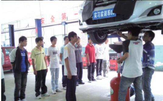
上面这两张图片是我们在进行汽车二级维护的上课情景。老师布置任务后，我们立即行动起来，先根据任务书明确知识点，再确认工作的程序，分工后逐一对汽车的发动机、刹车系统、电器、机油等进行检查维护。在此过程中，我们严格按相关的国家标准进行操作，并对整个过程进行记录，认真填写任务书。课后老师对我们的任务书进行了及时的批改和点评，使我们能够及时发现问题并确实掌握任务中所包含的知识和技能。
