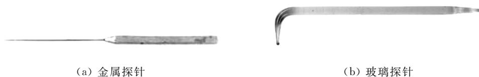
图 1-10 金属探针和玻璃探针
