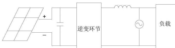
图 1-2 可调度式光伏并网发电系统
