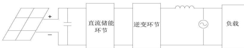
图 1-1 不可调度式光伏并网发电系统
