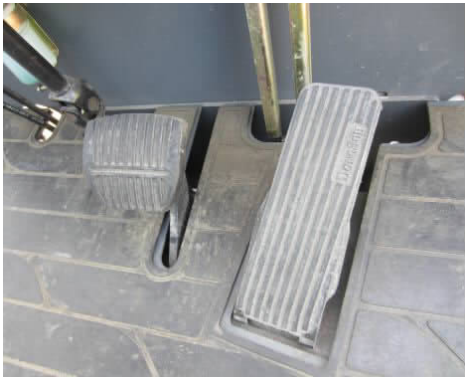
图 1-1-25 LG16B 蓄电池平衡重式叉车 左为脚制动踏板 右为加速踏板
