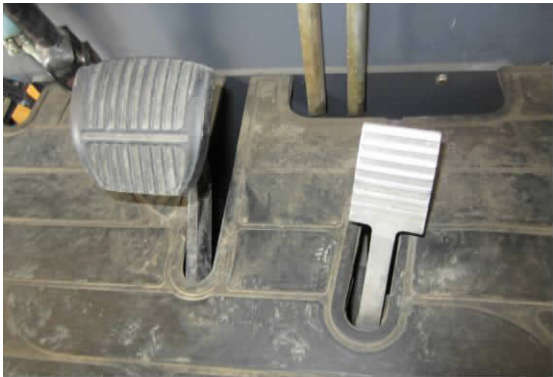
图 1-1-26 LG16BC 蓄电池平衡重式叉车 左为脚制动踏板 右为加速踏板 注意：两种型号加速踏板的不同
